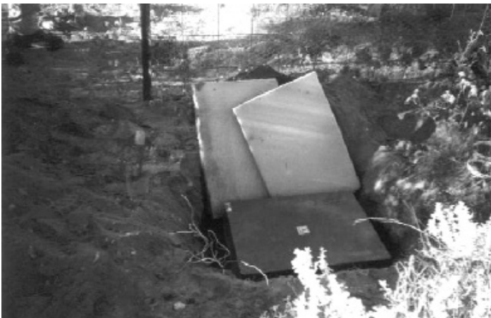
Fig. 2. Equipo de adquisición automática de datos ubicado en el terreno, antes de comenzar a realizar las mediciones. Se observan las planchas de goma espuma, que posteriormente eran ubicadas encima del equipo de adquisición automática de datos, incluido en la caja azul, que luego se cubría con suelo.
